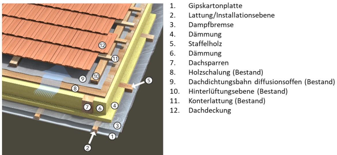
Abbildung 2: Aufbau einer Zwischensparrendämmung
